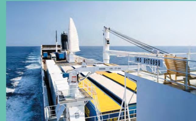
En 2023, la Compagnie Maritime Nantaise-MN a mis en œuvre le "proof of concept" de la solution Wisamo. Pour fiabiliser la technologie, un prototype d'aile à échelle 1/8 (100 m<sup>2</sup>) a été installé pendant 6 mois sur le Pelican, réalisant plusieurs allers-retours hebdomadaires dans le Golfe de Gascogne, bien connu des marins pour sa météo et ses vents capricieux.
